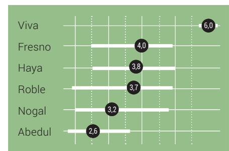
La prueba Brinell mide la dureza de la madera al ejercer presión sobre su superficie con una bola de acero pequeña mediante una carga pesada. El número Brinell se determinará en función del punzonamiento que se haya producido. Cuanto mayor sea el número Brinell, más dura y resistente será la madera. Los números que se muestran aquí son promedios basados en varias pruebas. Viva tiene el número Brinell más alto debido a su duro núcleo de HDF, que absorbe la fuerza de la bola.
